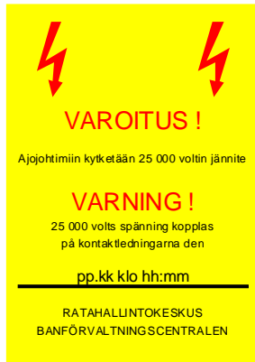
Kuva 17.6:13 Sähköradan rakennustyön varoitusmerkki T-131A.
